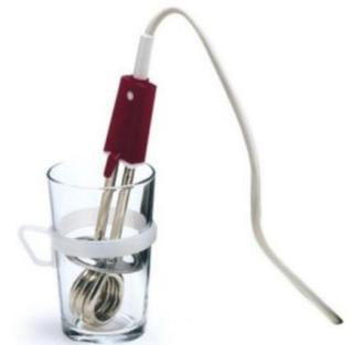
On cherche à déterminer l'énergie nécessaire pour faire passer 1g d'eau de l'état liquide à l'état gazeux. Pour cela on peut utiliser un thermoplongeur, qui est en fait une résistance chauffante qui a une puissance connue et constante.
