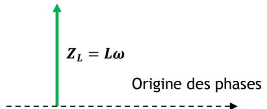
La tension entre les bornes de la bobine est en **avance de  $\frac{\pi}{2}$**  par rapport au courant.
