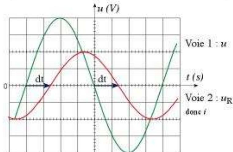
Exemple:  $dt = 1,4 \text{ div} \times 0,5 \text{ ms / div} = 0,7 \text{ ms}$
