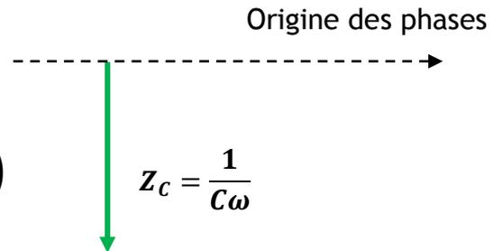
La tension entre les bornes du condensateur est en **retard de  $\frac{\pi}{2}$**  par rapport au courant.
