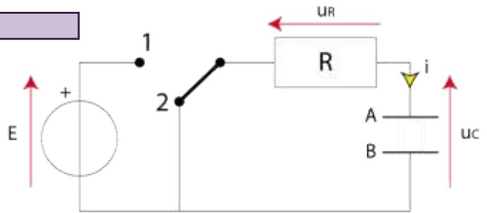
Le commutateur (interrupteur à plusieurs positions) a deux positions possibles repérées par 1 et 2. Une interface reliée à un ordinateur permet de saisir les valeurs instantanées de cette tension  $u_C(t)$ . Initialement, le commutateur est depuis longtemps en position 2 et le condensateur est déchargé.
