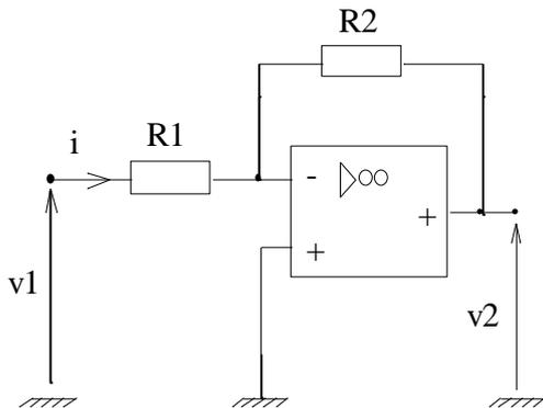
Données :  $R_1=1k\Omega$  et  $R_2=12k\Omega$
