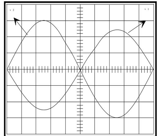
Calibres :  $v_1: 0,2V/div$  ;  $v_2: 2V/div$
